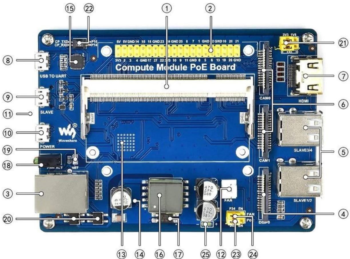
1. Interfaccia del modulo di calcola: per il collegamento del modulo di calcolo (cm3 / cm3L / cm3 + / cm3 + l)
